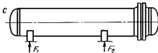
Цилиндрическая обечайка, не подкрепленная элементами жесткости
