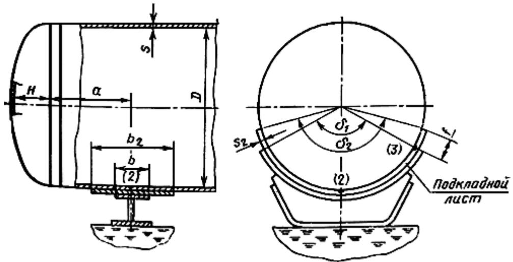
Цилиндрическая обечайка, подкрепленная кольцами жесткости
